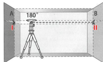
Allineare l'altezza dello strumento di misura (usando un treppiede o il supporto a muro se necessario) in modo tale che il punto di incrocio delle linee laser venga proiettato contro il punto II
