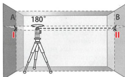
Richten der Höhe des Messgerätes (indem ein Stativ oder der Wandhalter bei Bedarf verwendet wird), so dass der Sch-
