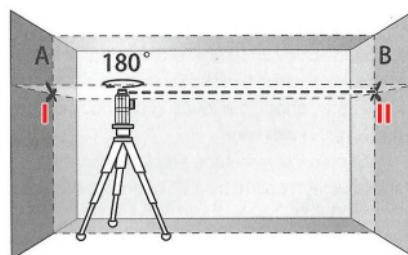
Alignez la hauteur de l'instrument de mesure (en utilisant un trépied ou le support mural si nécessaire) de telle sorte que le point d'intersection des lignes laser est projeté contre le point II sur le mur B marqué précédemment.
