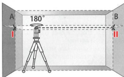
Alinee la altura del instrumento de medición (utilizando un trípode o el soporte de pared si es necesario) de manera que el punto de intersección de las líneas láser se proyecte con-
