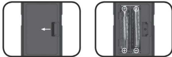
Ouvrez le couvercle des piles à l'arrière de l'appareil et placez les piles en respectant la polarité, puis refermez le couvercle. Utilisez des piles AAA 1,5 V.
