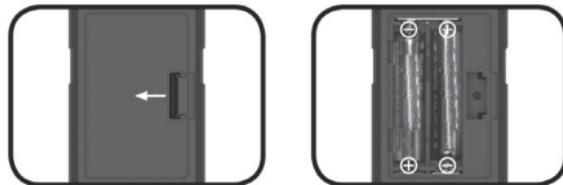
Abra la tapa de las pilas situada en la parte posterior del aparato e inserte las pilas, respetando la polaridad correcta, y cierre la tapa.
