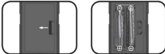
Öffnen Sie den Batteriedeckel auf der Rückseite des Geräts und legen Sie die Batterien unter Beachtung der Polarität ein; schließen Sie dann den Deckel wieder.
