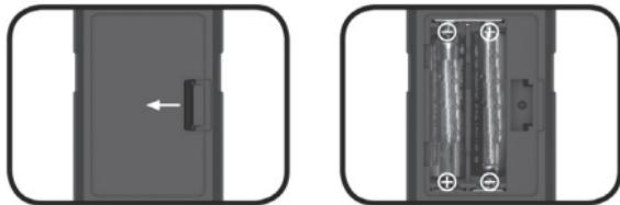
Aprire lo sportello delle batterie sul retro del dispositivo e posizionare le batterie secondo la corretta polarità, quindi chiudere lo sportello della batteria.
