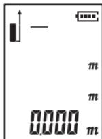
In modalità misura, premere a lungo per 2 secondi il pulsante per accedere alla modalità di misurazione continua.
