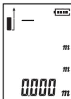
Im Messmodus halten Sie die Taste 2 Sekunden lang gedrückt, um in den Dauermessmodus zu gelangen.
