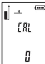
Per garantire la precisione dello strumento, è prevista una funzione di calibrazione. Nello stato di calibrazione: premere brevemente il pulsante per regolare il valore calibrazione.
