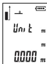
Drücken Sie in dieser Funktion kurz die Taste , um die Maßeinheit zu ändern.
