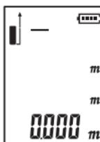
In modalità misura, premere brevemente il pulsante , e lo strumento emetterà il laser, puntare l'oggetto la cui distanza è da misurare, e premere di nuovo brevemente il pulsante per la misurazione di una singola distanza. Il risultato della misurazione viene visualizzato nell'area principale del display.
