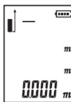
En el modo de medición, pulse brevemente el botón y el instrumento emitirá el láser, apunte al objeto cuya distancia desea medir y vuelva a pulsar brevemente el botón para realizar una única medición de distancia.
