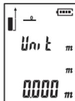
Nello stato di impostazione dell'unità, premere brevemente il pulsante per cambiare l'unità di misura.
