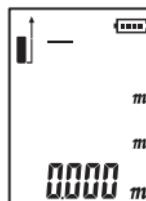
En mode de mesure, appuyez brièvement sur le bouton , l'instrument émet le laser, pointe l'objet dont la distance doit être mesurée, et appuyez à nouveau brièvement sur le bouton pour effectuer une mesure de distance unique.
