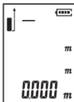
En mode de mesure, appuyez sur le bouton pendant 2 secondes pour passer en mode de mesure continue.
