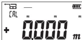
L'utilisateur peut ajuster les chiffres en fonction de la précision de l'appareil à l'aide des boutons
